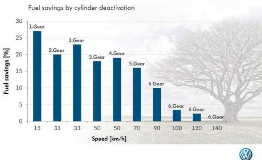
Εικόνα 2.6.29 Διάγραμμα μείωσης της κατανάλωσης καυσίμου με την χρήση του συστήματος απενεργοποίησης κυλίνδρων της Volkswagen (πηγή: autotriti.gr)
