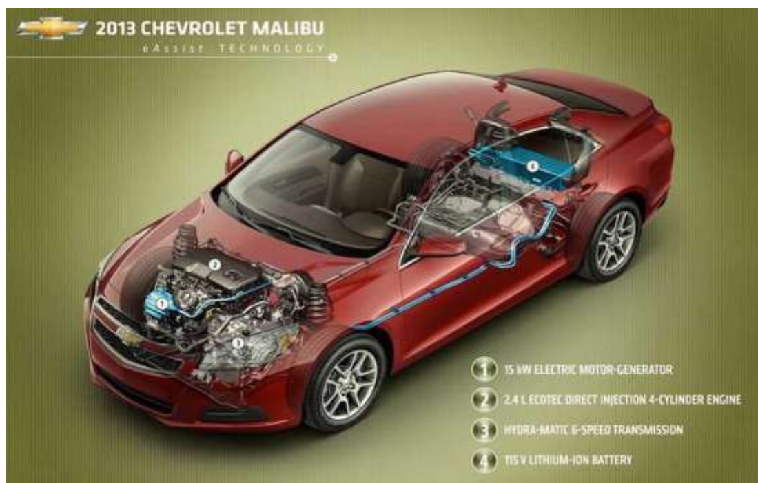
Εικόνα 2.6.30 Παράδειγμα εφαρμογής υβριδικής τεχνολογίας από την εταιρεία Chevrolet (πηγή: www.caroto.gr )
