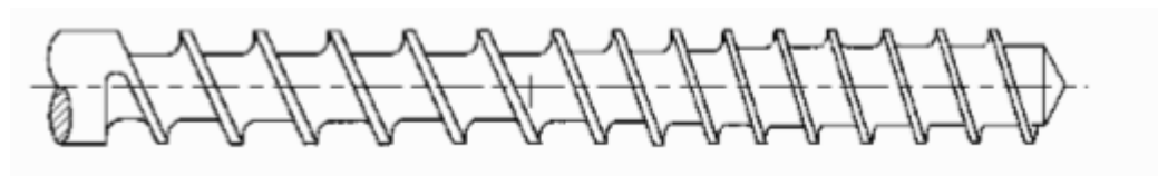
Σχήμα 2.13(β): Κοχλίας εκβολέα με μεταβλητό ελαττούμενο βήμα.
