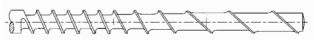
Σχήμα 2.13(α): Κοχλίας εκβολέα με μεταβλητό αυξανόμενο βήμα.
