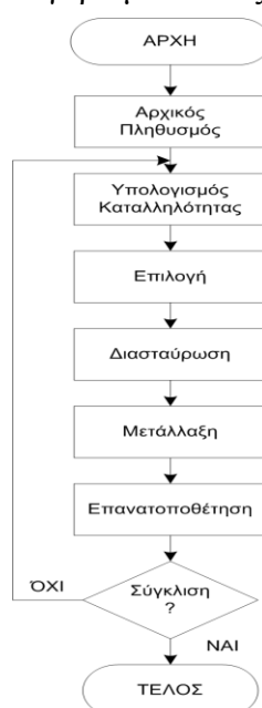
Εικόνα 2.2.3: Η βασική λειτουργική δομή ενός τυπικού ΓΑ
