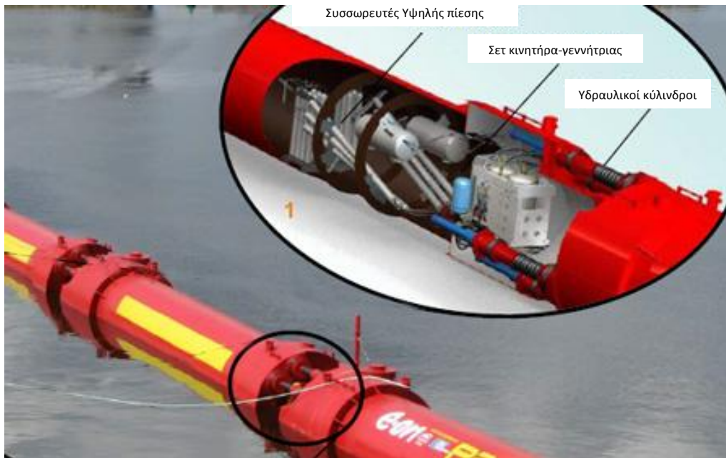
Εικόνα 4.η: Το εσωτερικό του ηλεκτρο-υδραυλικού συστήματος μιας Pelamis
