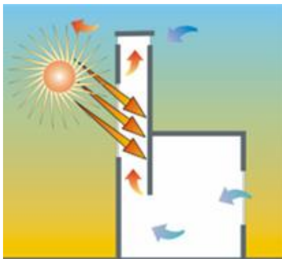
Λειτουργία για ηλιακής καμινάδας (πηγή : www.cres.gr )
