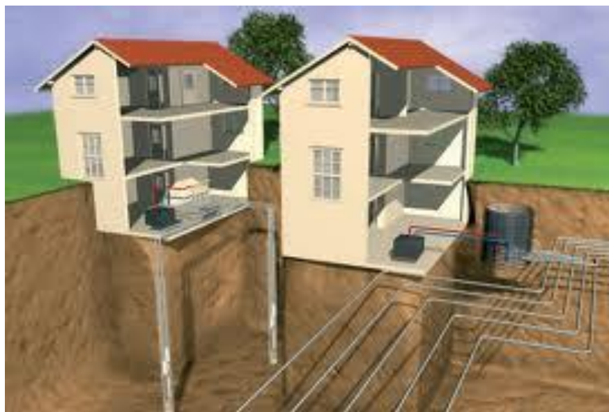
Κατακόρυφοι και οριζόντιοι υδρωληνίοι γεωθερμικού συστήματος
