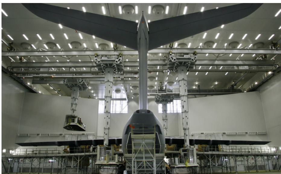
Εικόνα 2.5 : Κατασκευή ατράκτου και πίσω μέρος πτερυγίων.
