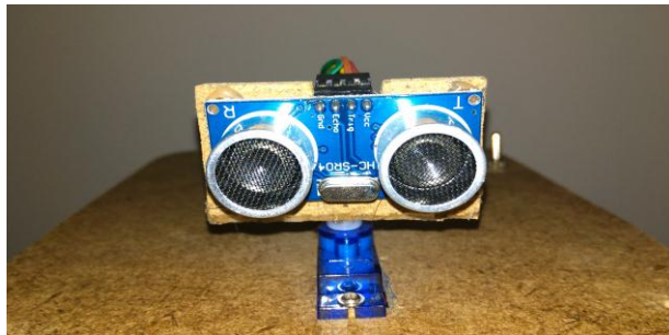
Ο αισθητήρας υπερήχων (sonar) για εντοπισμό και αποφυγή εμποδίων
