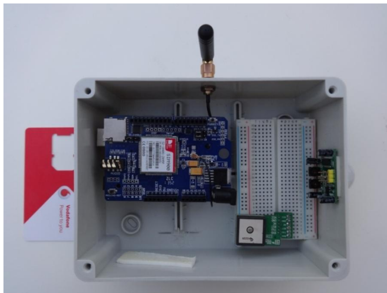
Εικόνα 26. Διαδικασία συναρμολόγησης κατασκευής εντός του κατάλληλου κουτιού
