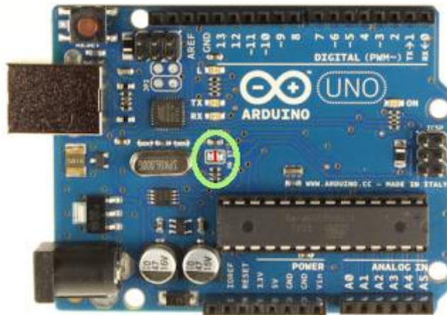
Εικόνα 6. Γραμμή σύνδεσης και ελέγχου του αυτομάτου reset
