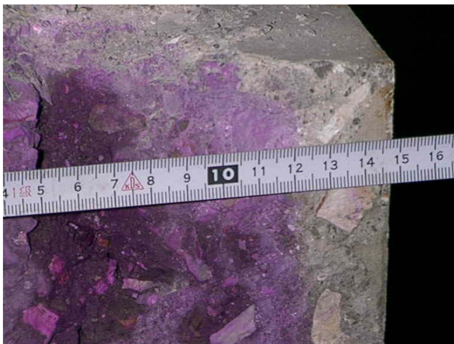
Εικόνα 6: Δοκίμιο σκυροδέματος, στο οποίο φαίνεται το βάθος ενανθράκωσης.
