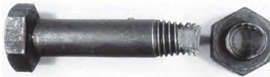
Εικόνα 15: Αστοχία κοχλία σε εφελκυσμό - Πηγή: Σημειώσεις «ΣΙΔΗΡΕΣ ΚΑΤΑΣΚΕΥΕΣ II» Εθνικού Μετσόβιου Πολυτεχνείου - Διάλεξη III
