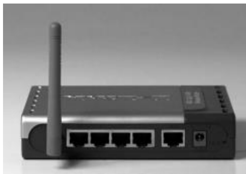
Εικόνα 12 – Το σημείο πρόσβασης τύπου DI-524 της εταιρίας D-Link με ενσωματωμένο το τείχος προστασίας.
