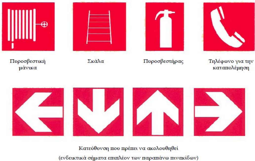
Εικόνα 20 Πινακίδες πυρασφάλειας και προσανατολισμού σε κατάσταση κινδύνου
