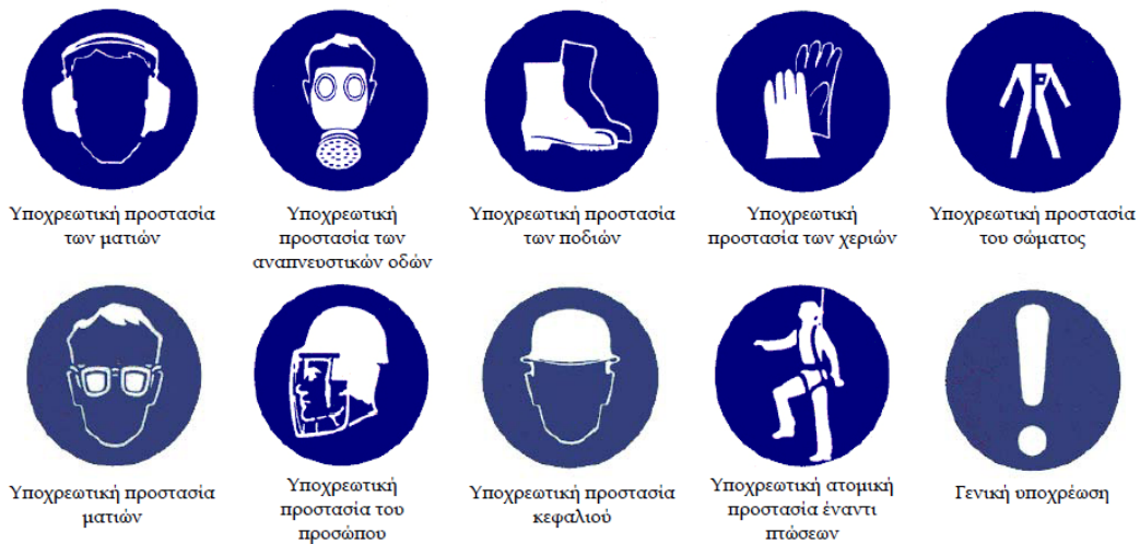
Εικόνα 18 Πινακίδες υποχρέωσης και υποχρεωτικών ενεργειών
