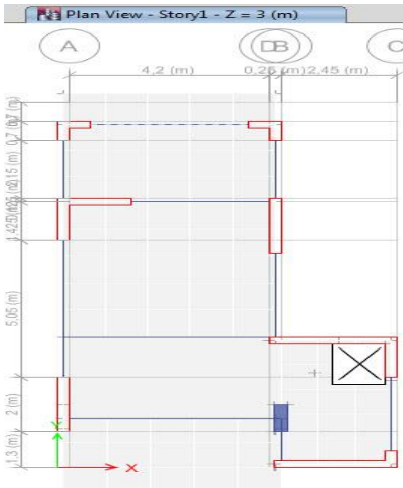
Σχήμα 5.4.14.22 Κάνναβος με τοιχεία, δοκούς, υποστύλωμα και πλάκες
