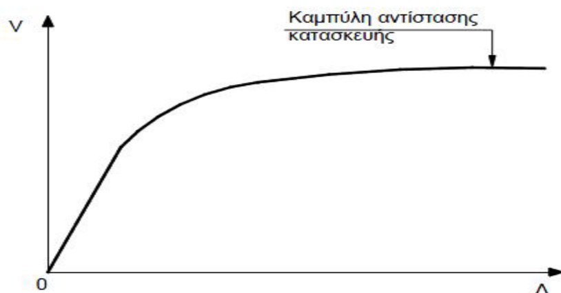
Σχήμα 3.2. Καμπύλη pushover (ATC 40) (Κόντου, 2010)
