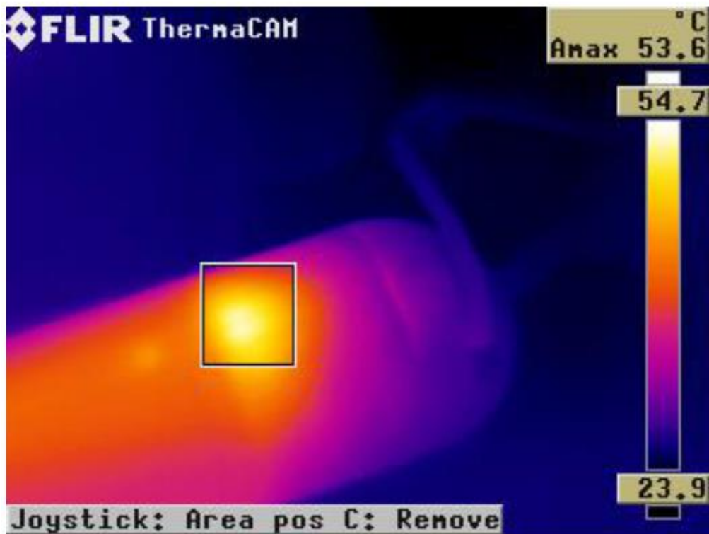
Σχήμα 3.5 Σε αυτή την εικόνα η περιοχή λειτουργίας έχει τεθεί έτσι ώστε να δείχνει την μέγιστη θερμοκρασία στο κουτί.
