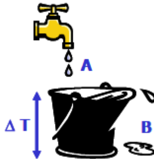
Σχήμα 5.9 Σε μόνιμη κατάσταση ότι μπαίνει μέσα ισούται με ότι βγαίνει έξω.-η ισχύς θέρμανσης ισούται με την ισχύ ψύξης
