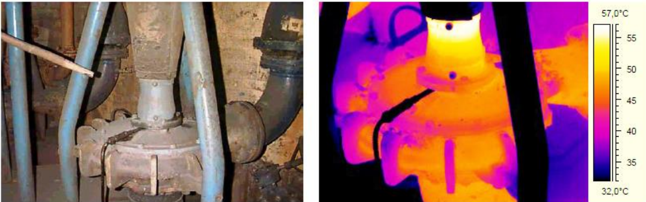
Σχήμα 10.6 Φωτογραφία και θερμική εικόνα ύποπτου ρουλεμάν αντλίας
