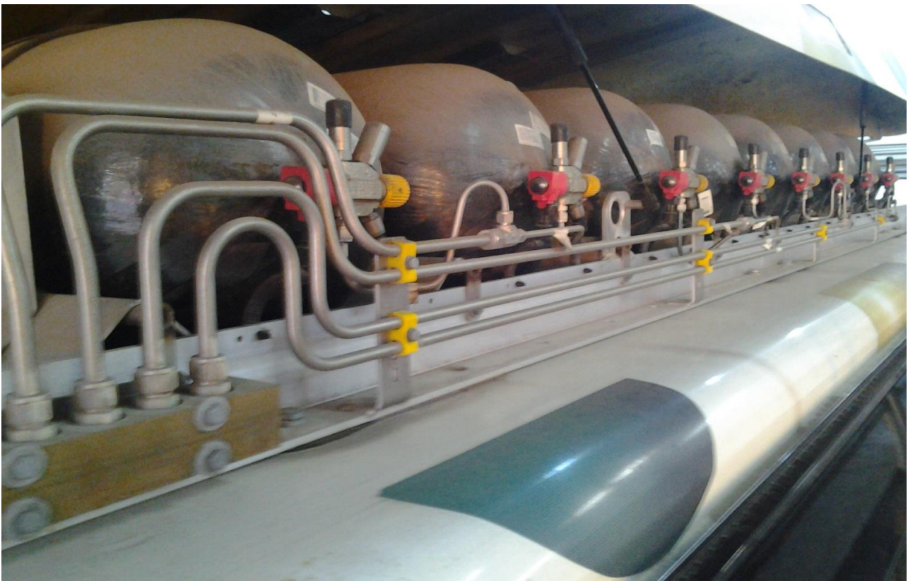
Οροφή του λεωφορείου με τις 8 μπουκάλες αερίου
