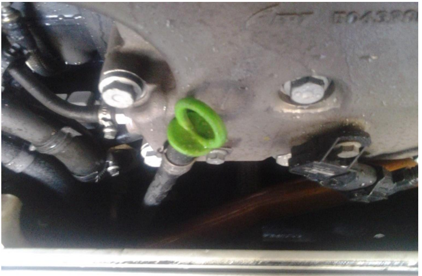
Εικόνα αισθητήρα- ανιχνευτή ποσότητας αέρα ο οποίος είναι εφαρμοσμένος στη πολλαπλή εισαγωγής
