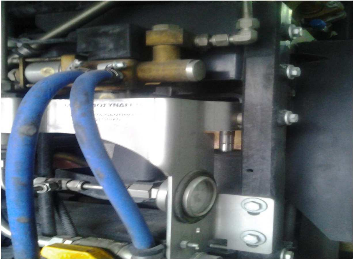
βαλβίδα με μετρητικό ρολόι παροχής και ρυθμιστής πίεσης
