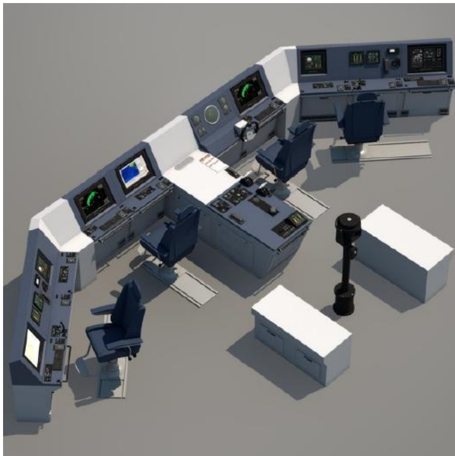
3.1.α. Κεντρικό σύστημα ελέγχου σε 3D
