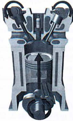
Σχήμα 2.2: Τετράχρονος κύλινδρος βενζινοκινητήρα
