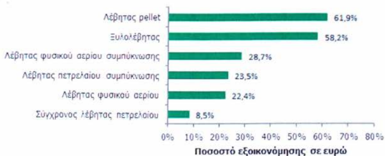
Γράφημα 4.2 Ετήσια εξοικονόμηση ενέργειας σε αξία σε σχέση με κλασικό λέβητα πετρελαίου [26]
