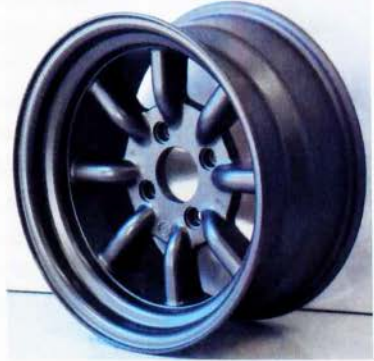
Εικόνα 6.8 Παραδείγματα εφαρμογών μαγνησίου στην αυτοκινητοβιομηχανία
