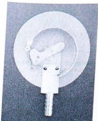
Εικόνα 4-8 Πίσω όψη μανομέτρου τύπου Burdon
