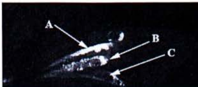
Εικόνα 3-10 Ασταθής κατάσταση στην πλευρά της αναρρόφησης. NPSH=8m
