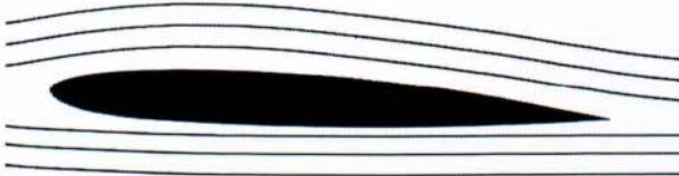
Σχήμα 3.3 Κανονική ροή κατά πλάτους της αεροτομής. (Πηγή: The Aviation History Online Museum)
