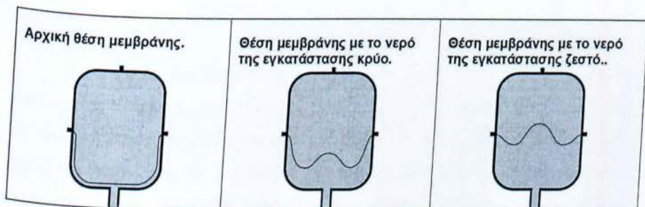
ΣΧΗΜΑ 4.6 Θέση μεμβράνης εντός του δοχείου διαστολής [23]
