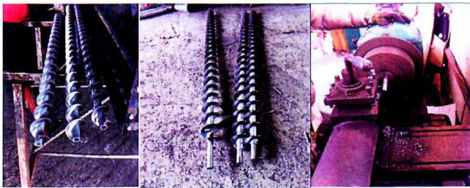
Εικ. 28 Κατασκευή κοχλιών μεταφοράς
