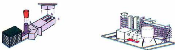
Εικ.10 Καυστήρας - θέση του στο ξηραντήριο
