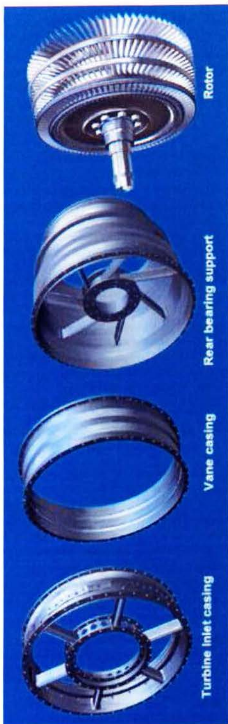
Εικόνα 29 3D Απεικόνιση τμημάτων και του στροφοπίου του στροβίλου
