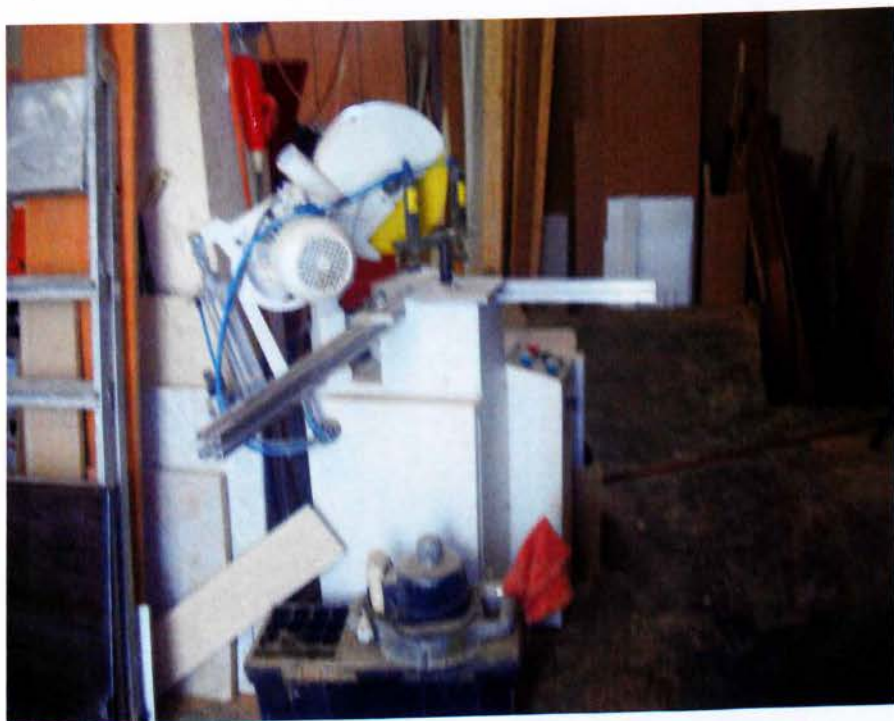
Φαλτσοκόφτης (2 σκάλων) 1 η ) 2.2 KW 2840 min -1 2 η ) 2.54 KW 3380 min -1
