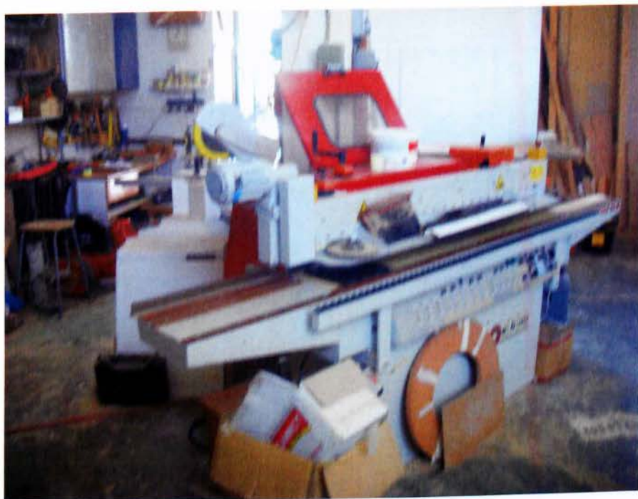
Φαλτσοκόφτης (2 σκάλων) 1 η ) 2.2 KW 2840 min -1 2 η ) 2.54 KW 3380 min -1
