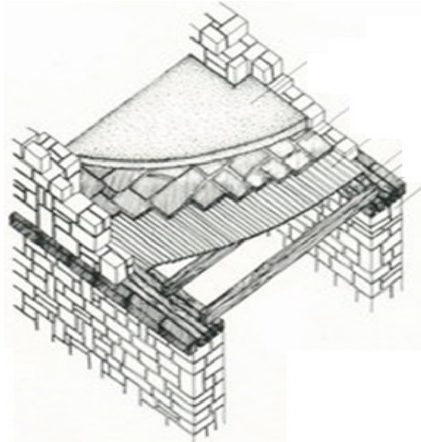
Εικόνα 13 Η επιφάνεια κίνησης μπορεί να αποτελείται από σανίδες, μάρμαρο, σχιστόπλακες, πήλινα πλακίδια κ.α. Για την πρόσδωση στα πατώματα θερμομονωτικών και ηχομονωτικών ιδιοτήτων χρησιμοποιούνται και άλλα υλικά, όπως λάσπη, άμμος και πλίνθοι.
