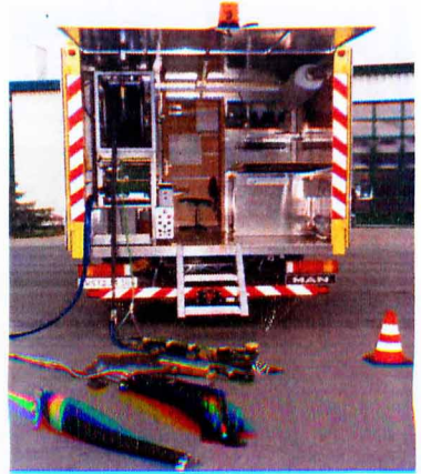
Εικόνα 5.1 : Οχήμα τηλε-επιθεώρησης και επισκευής δικτύων (Κοπτικό) (ΕΥΔΑΠ 2012)
