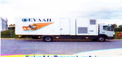
Εικόνα 5.1 : Οχήμα τηλε-επιθεώρησης και επισκευής δικτύων (Κοπτικό) (ΕΥΔΑΠ 2012)
