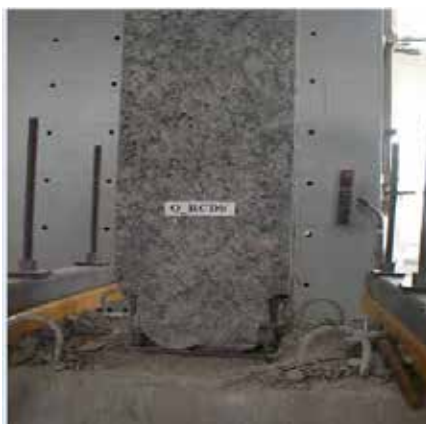
Εικόνα 8.1: Βλάβες σε δοκίμιο με εκτοξευόμενο σκυρόδεμα και βλήτρα
