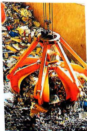
Εικόνα 4.3 Γερανός "αρπαγής" αποβλήτων[13]
