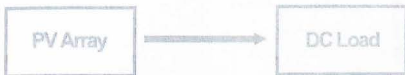
Εικόνα 2.9 : Η φωτοβολταϊκή συστοιχία συνδέεται άμεσα με ένα DC φορτίο. [53]
