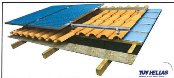
Εικόνα 3.14: Βάση στήριξης φωτοβολταϊκών πλαισίων σε σκεπή
