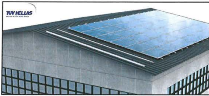
Εικόνα 3.15: Βάση στήριξης φωτοβολταϊκών πλαισίων σε βιομηχανική στέγη
