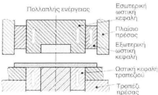
Σχήμα 5.5.3: Λειτουργία πρέσας πολλαπλής ενέργειας.
