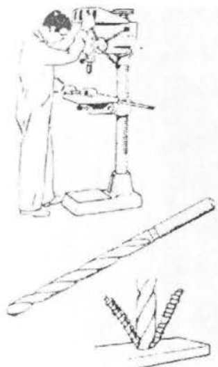
Σχήμα 3. 1: Κατεργασία με βαθμιαία αφαίρεση υλικού ( Διάτρηση ).
