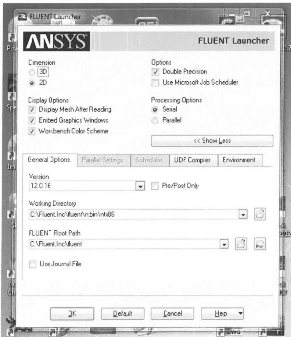
Σχήμα 5.3: Παράθυρο επιλογής dimension στο FLUENT.
