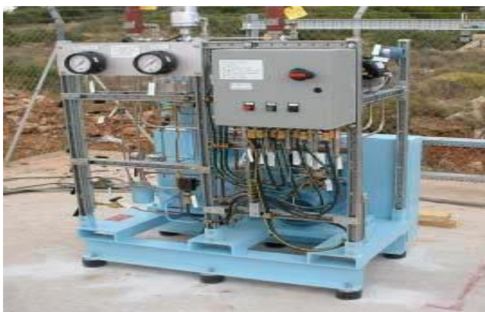
Σχήμα 2.23 Ο συμπιεστής υδρογόνου στο αιολικό πάρκο του ΚΑΠΕ
