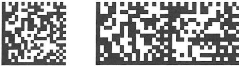
Εικόνα 3.1: Τετράγωνο και ορθογώνιο Data Matrix
