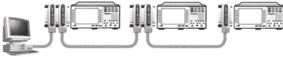
Παράδειγμα διασύνδεσης οργάνων που φέρουν πρότυπο GPIB.
