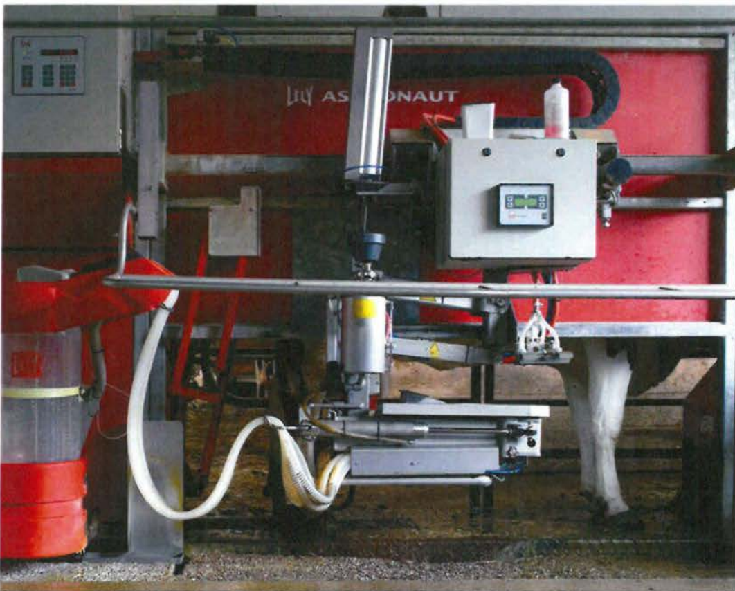
Εικόνα 4.6 Θάλαμος ακινητοποίησης ζώου για άλμεξη από τον ρομποτικό βραχύωνα
