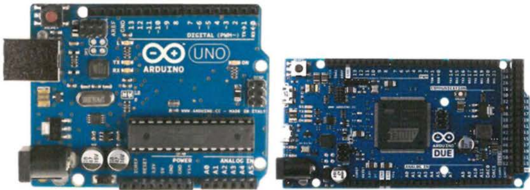
Εικόνα 1.6 Αριστερά : Arduino Uno - Δεξιά : Arduino Due
