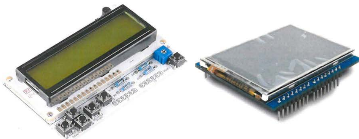
Εικόνα 1.24 Αριστερά : Arduino LCD Shield - Δεξιά : Arduino TFT LCD Touch Shield
