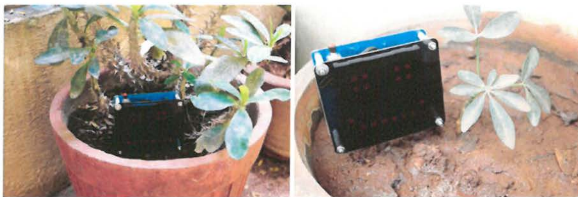
Εικόνα 1.31 - 8x8 Led Matrix Display εμφανίζεται ένα ένα χαρούμενο πρόσωπο και ένα σοβαρό πρόσωπο
