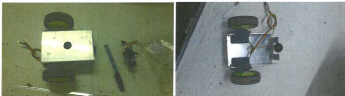
Εικ. 5.1 ε,ζ) Τοποθέτηση κινητήρων , τροχών και βοηθητικής μπίλιας
