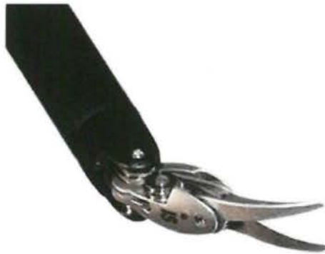
Εικ. 2.19 Ρομποτικό εργαλείο τύπου EndoWrist
