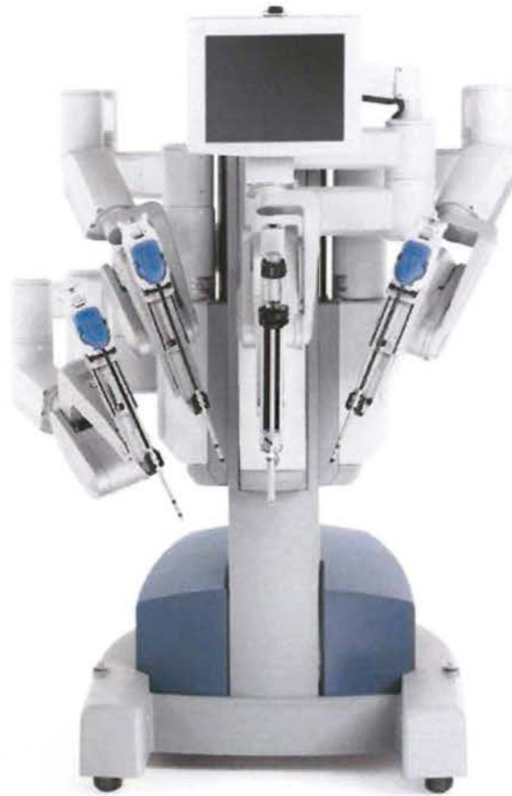
Εικ. 2.18 Τροχήλατο των ρομποτικών βραχιόνων
