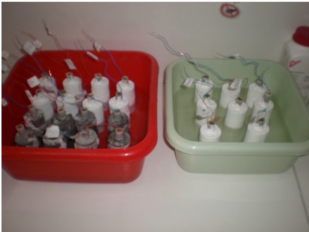
Φωτογραφία 2. Δοκίμια κατά τη διάρκεια της εμβάπτισης τους στο διάλυμα 3,5% κ.β. NaCl
