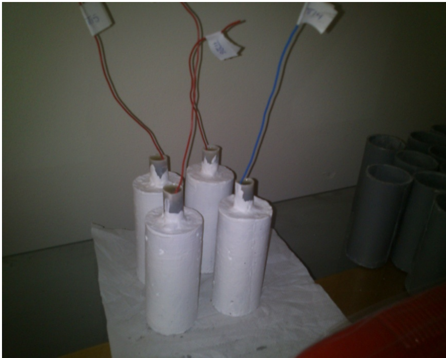
Φωτογραφία 1. Δοκίμια πριν την εμβάπτιση τους στο διάλυμα 3,5% κ.β. NaCl
