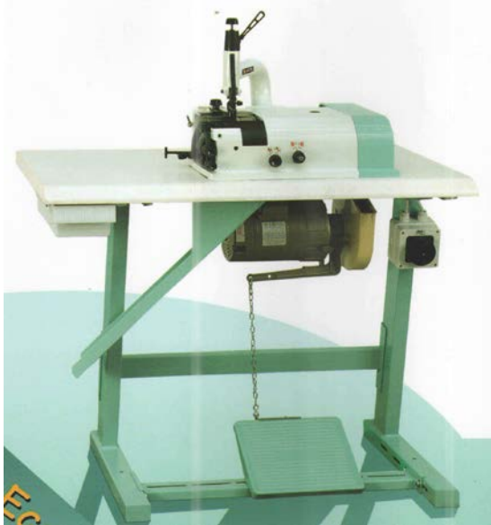
Εικόνες 3.10 Ρεφυλλάρισμα – Μηχανή και Ρεφυλλαρισμένα Κομμάτια Δερμάτων
