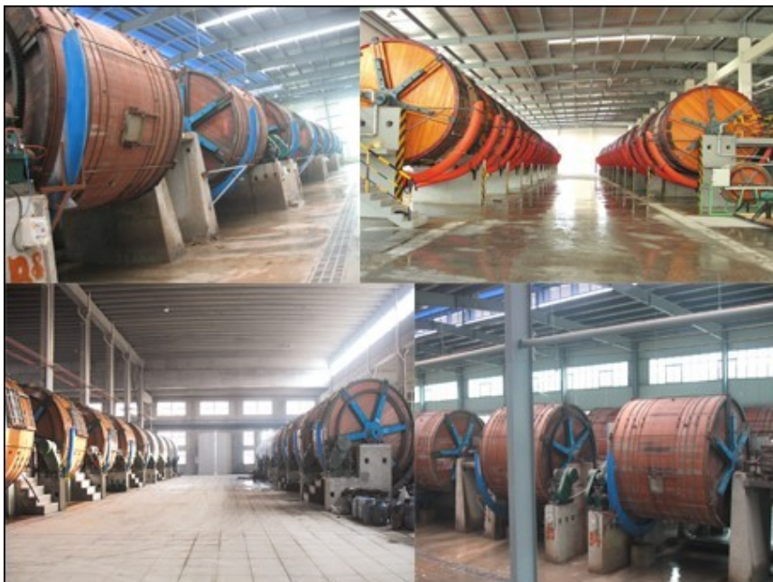
Εικόνα 2.2 Ξύλινες Βαρέλες Επεξεργασίας Δερμάτων
