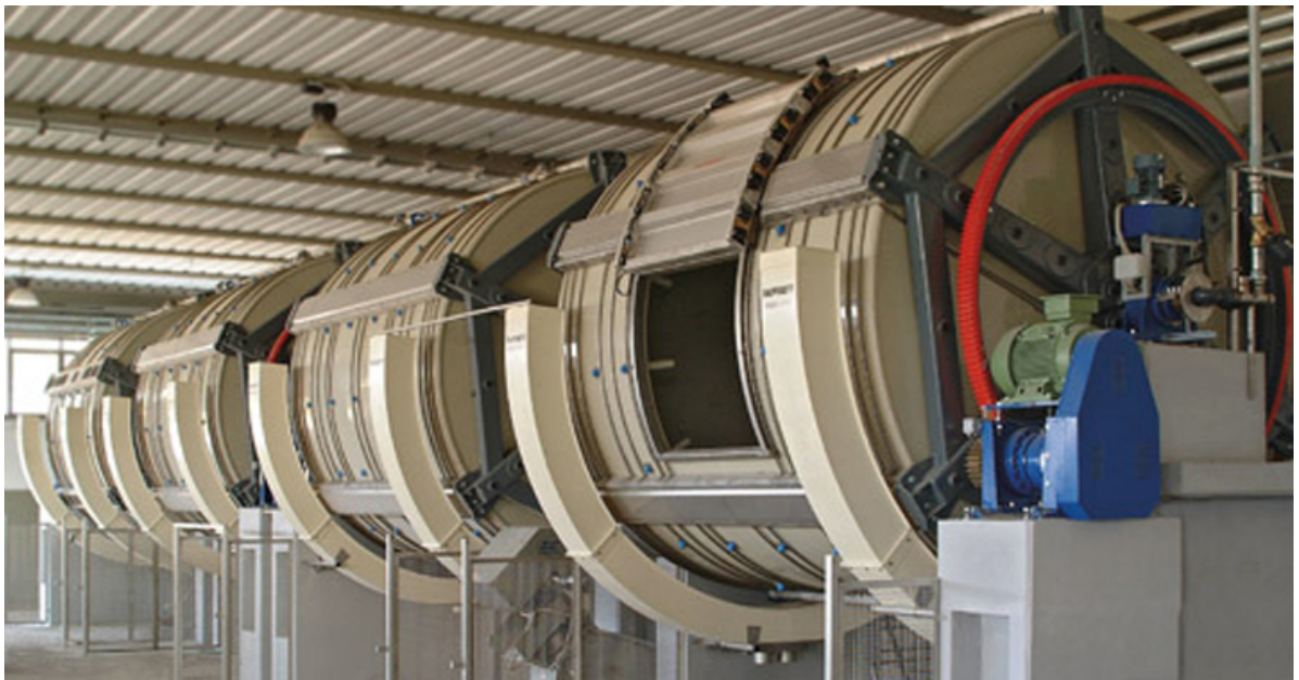
Εικόνα 2.3 Σύγχρονες Μεταλλικές Βαρέλες Επεξεργασίας Δερμάτων
