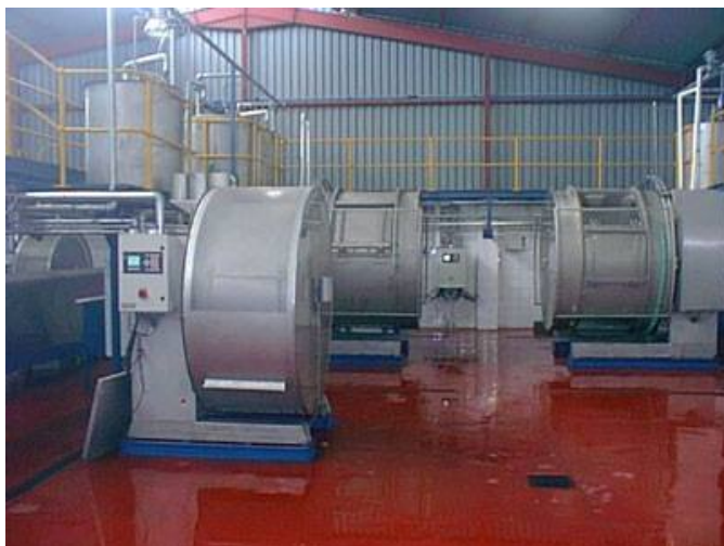
Εικόνες 2.4 – 2.5 Σύγχρονες Μεταλλικές Βαρέλες Επεξεργασίας Δερμάτων
