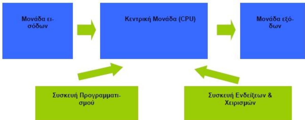
Σχέδιο 5.1 Βασικός τρόπος λειτουργίας των PLC
