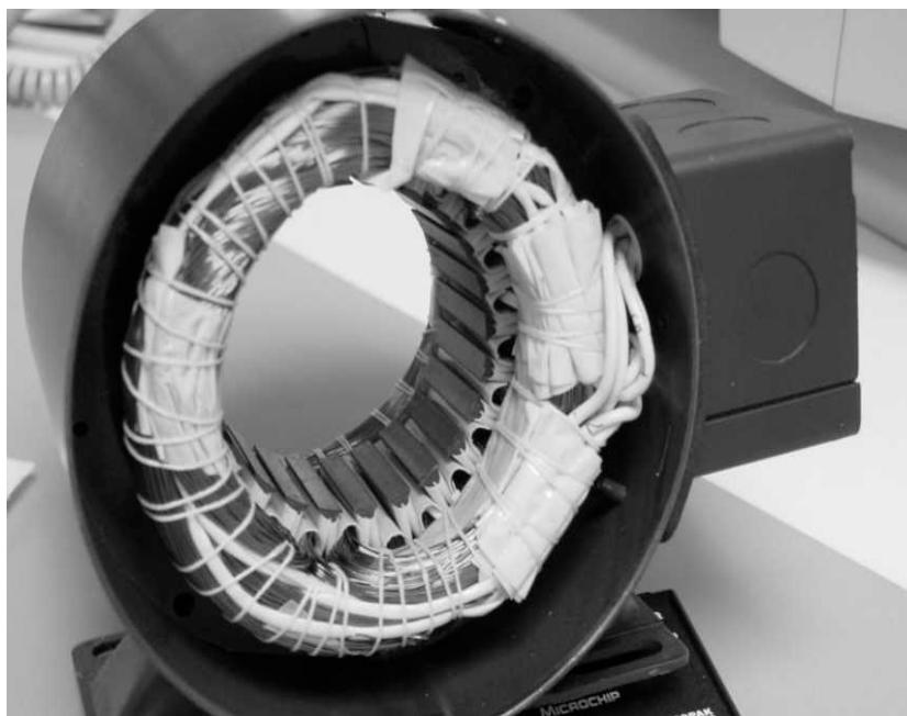
Σχ.2.2 Στάτης μηχανής brushless, όπου φαίνονται οι εγκοπές στην εσωτερική περιφέρεια του στάτη, οι πυρήνες και τα τυλίγματα.
