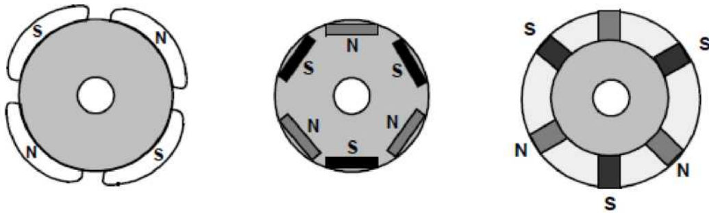
Σχ.2.4 Διαφορετικές τοποθετήσεις μαγνητών πάνω στον δρομέα. Στον πρώτο δρομέα οι μαγνήτες τοποθετούνται πάνω στην περιφέρεια, στον δεύτερο δρομέα οι ορθογώνιοι μαγνήτες τοποθετούνται οριζόντια κάτω από την περιφέρεια, ενώ στον τρίτο δρομέα τοποθετούνται κάθετα.
