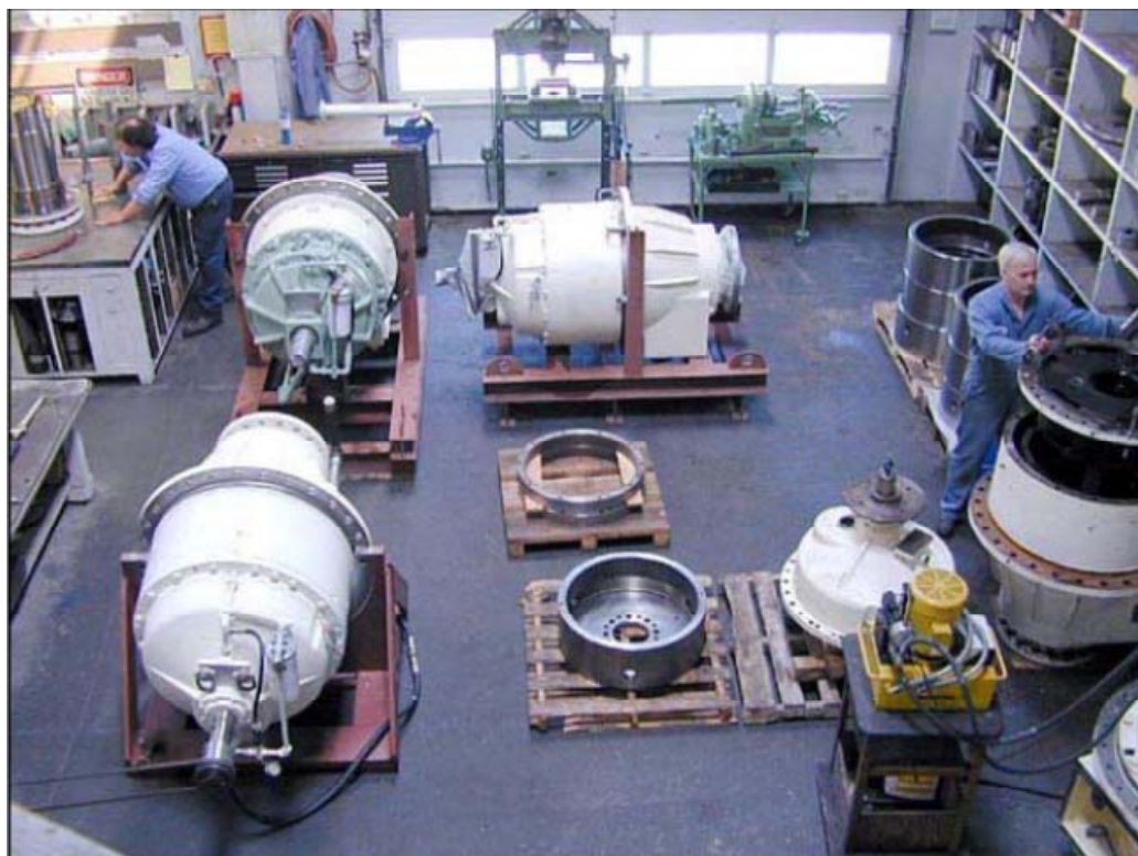
Σχήμα 8 .Κιβώτιο ταχυτήτων ανεμογεννήτριας κατά την κατασκευή του
