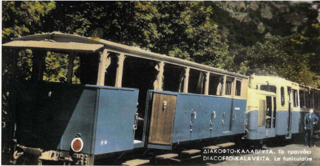
Δηξεληλεκτρικός συρμός του οδοντωτού στην Τριζιλιά, αποτελούμενος από το θερινό βαγόνι ΔΚ 111, το ΟΠΕ και την Α/Α Billard (1960, Αρχείο Κων. Παπαγεωργίου)
