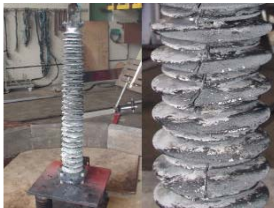
Σχήμα 4.19 Συμπεριφορά απαγωγού πορσελάνης σε βραχυκύκλωμα
