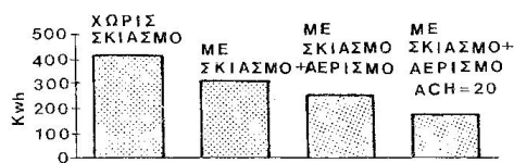
Σχήμα 23. Ιούλιος - Ψυκτικό φορτίο κατοικίας, ανάλογα με το σύστημα ψύξης
