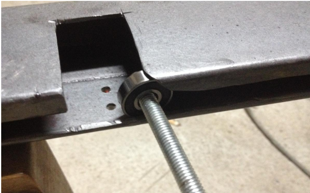
Ροδάκι και ντίζα στον διάδρομο που θα κινούνται
